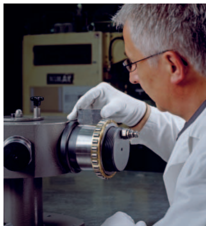
12: Měření vzdálenosti k nákržku na hřídeli
