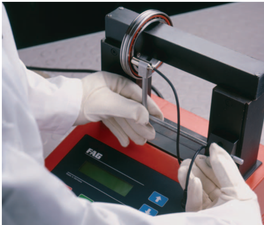
3: Ohřev vřetenového ložiska pomocí indukčního ohřívacího přístroje
