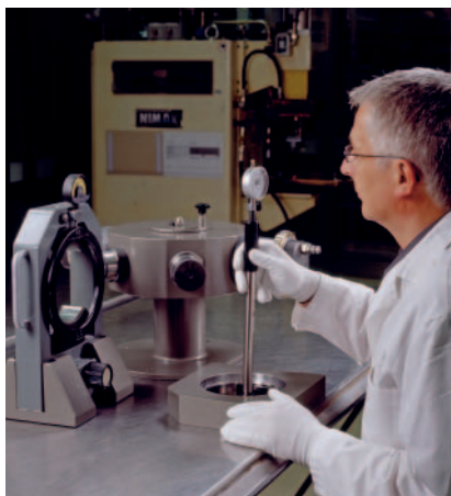
9: Měření průměru oběžné dráhy vnějšího kroužku
