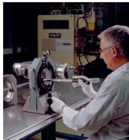
10: Přenos průměru oběžné dráhy na měřicí přístroj obalové křivky
