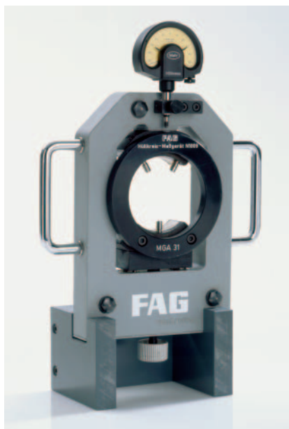
15: Měřicí přístroj obalové křivky FAG MGA 31 pro nastavení radiální vůle resp. předpětí válečkových ložisek se snímatelným vnějším kroužkem
